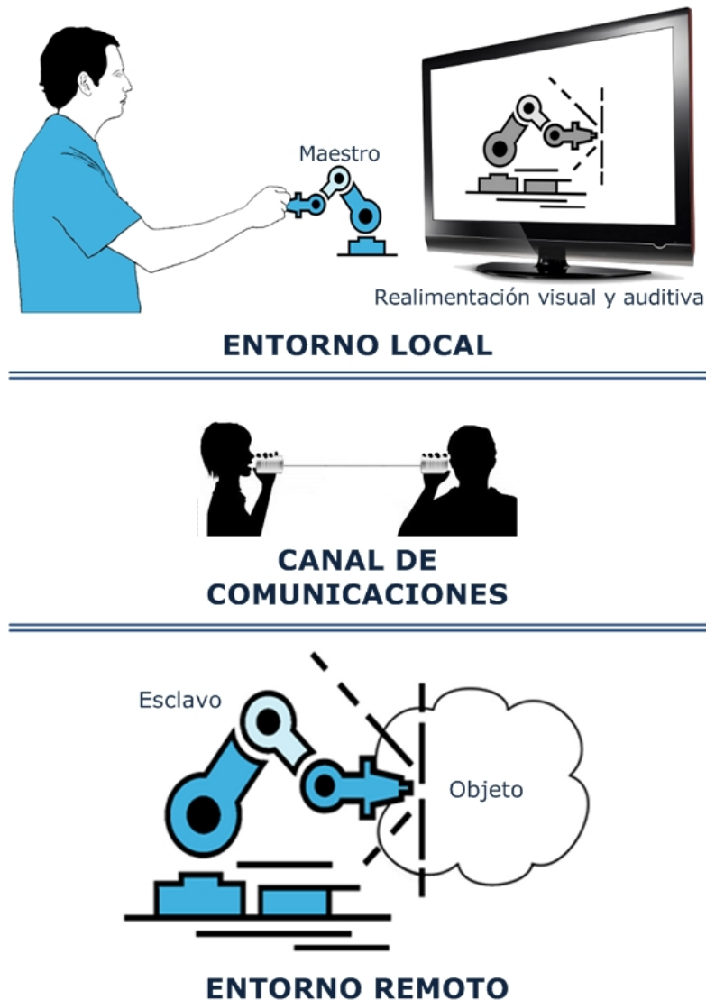
Figura 2.1: Componentes de un sistema teleoperado
