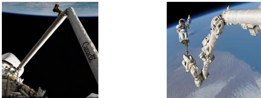
Figura 1.1: Canadarm en la estación espacial de la NASA (Izq.); Canadarm2 sujetando un astronauta (Der.) Fuente: Canadian Space Agency
