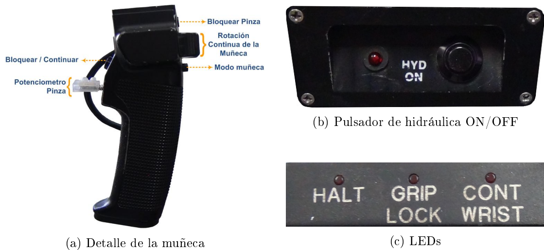
Figura 4.5: Pulsadores, leds y potenciómetros del maestro GRIPS
