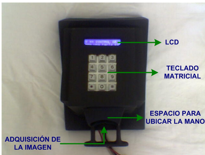
Fig. 10. Dispositivo de interacción con el usuario desarrollado
